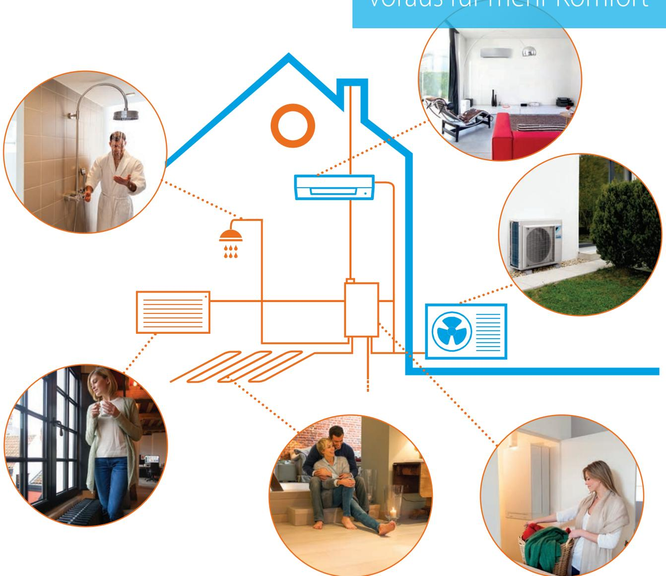
Die Hybrid Multi kombiniert ein Multi-System mit einer Hybrid-Wärmepumpe. Ein Anschluss kann für die Warmwassererzeugung genutzt werden, die anderen Anschlüsse für das Kühlen Ihres Zuhauses. Somit stellt die Hybrid Multi ein All-in-One-System für Kühlen, Heizen und Warmwassererzeugung dar. Eine Hybrid Multi kann problemlos installiert und anhand einer App auf dem Smartphone oder Tablet bedient werden und stellt die intelligente DAIKIN Lösung für Komfort zu jeder Jahreszeit dar.
